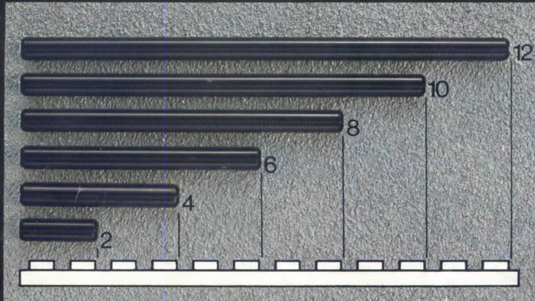
In der Bauanleitung steht vor den Achsen eine Zahl, die die benötigte Länge der Achsen angeibt.
